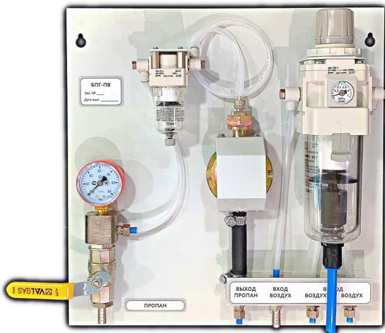
**Рис. 2. Блок подготовки газов пропан – воздух**
