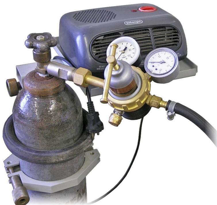
**Рис.11. Подогрев редуктора с закисью азота**
