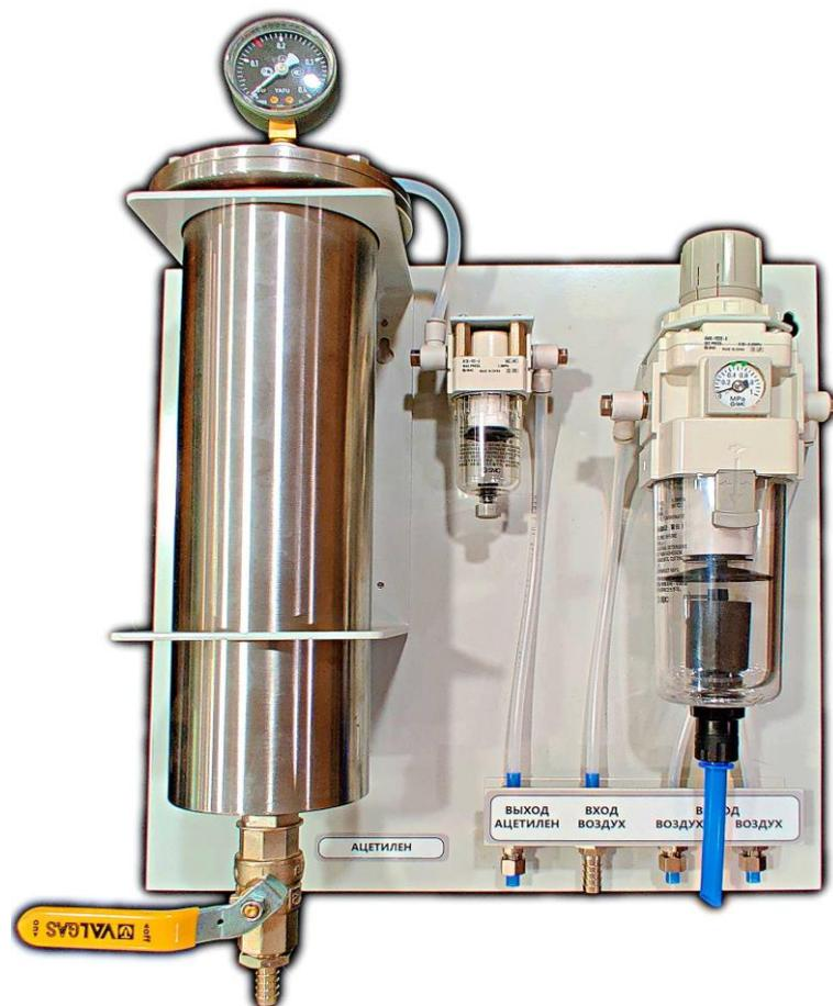
**Рис. 3. Блок подготовки газов ацетилен – воздух**
