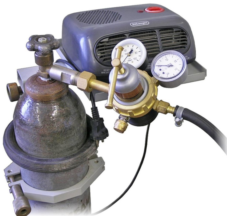
Рис.11. Подогрев редуктора с закисью азота
