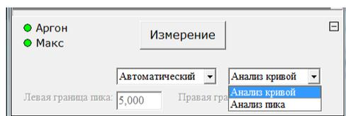
В автоматическом режиме (задан по умолчанию) границы интегрирования определяются в зависимости от выбранного режима «Анализ кривой» или «Анализ пика» - в первом случае анализируется производная сигнала интегрирования, во втором - высота пика. Алгоритмы выбираются оператором в зависимости от условий проведения анализа и концентрации в исследуемой пробе.
