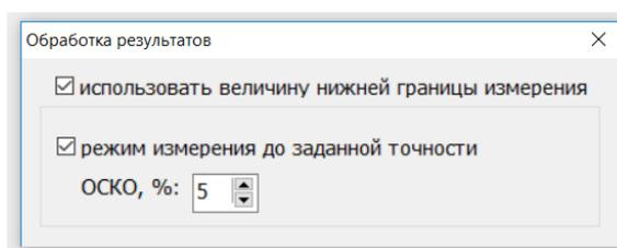
При включении режима **«использовать величину нижней границы измерения»** программа в процессе построения калибровки рассчитывает предел обнаружения, по величине которого определяется значение нижней границы измерений. Результат выводится в виде:  $< A$ , где  $A$  – нижняя граница измерений для используемой калибровки.
