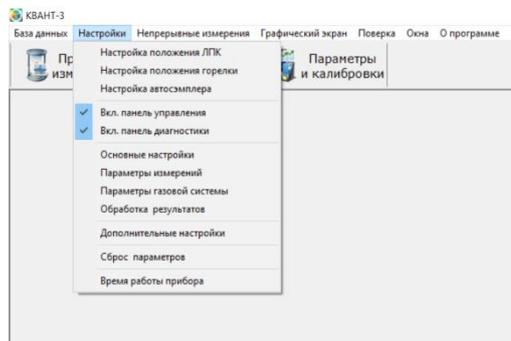
**Непрерывные измерения** - позволяет контролировать сигнал поглощения или величину концентрации (при условии подключённой градуировки) в реальном времени
