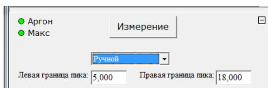
**ПРИМЕЧАНИЕ:** В автоматическом режиме программа расставляет границы интегрирования после каждого цикла измерения, в ручном режиме границы определяются оператором и в следующих измерениях их положение не меняется. Параметры градуировочного графика используются программой при анализе неизвестных проб.
