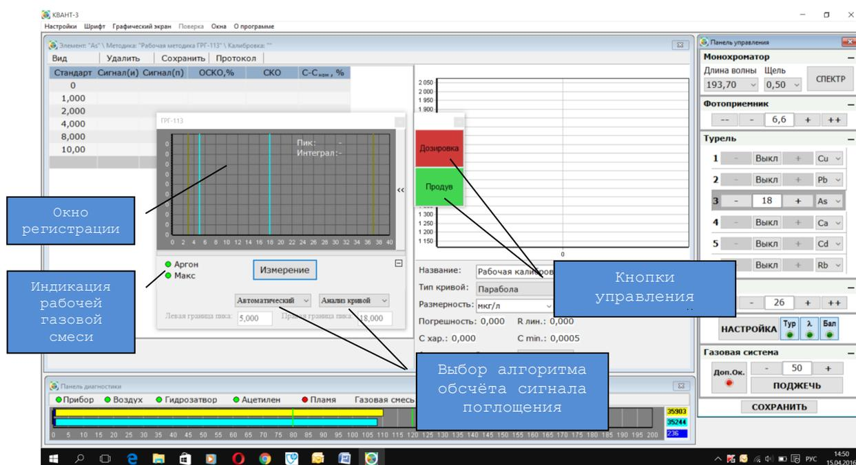
Рис. 26 Окно режима «Измерение» ГРГ-113
