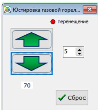
Вид окна управления показан на рис. 10. Диапазон перемещений равен 140 шагам, один шаг соответствует перемещению на 0,1 мм.
