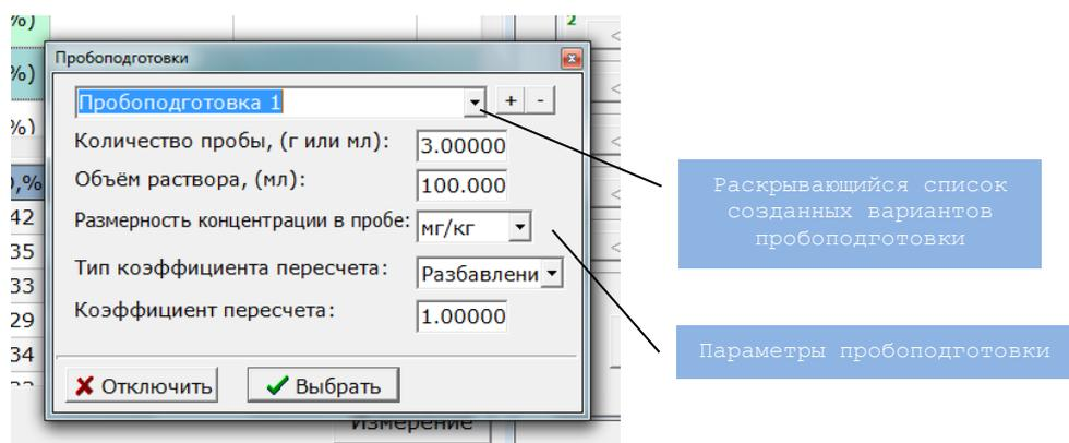
В раскрывающемся списке созданных вариантов пробоподготовки определиться с нужным вариантом и нажать кнопку **«Выбрать»**.
