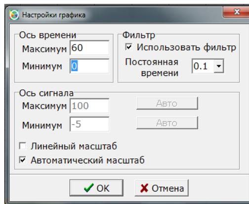
Настройка диапазона отображения уровня сигналов «Ось сигнала» задаётся в окнах «Максимум» и «Минимум». При отключённой опции «Автоматический масштаб» диапазон отображения сигналов подбирается нажатием кнопок «Авто».
