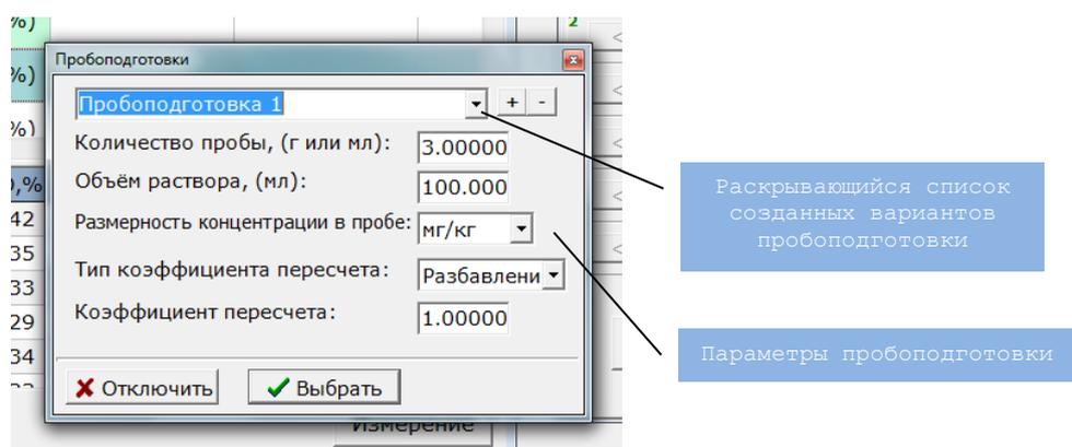
2. В раскрывающемся списке созданных вариантов пробоподготовки выбрать нужное и нажать кнопку **«Выбрать»**.
