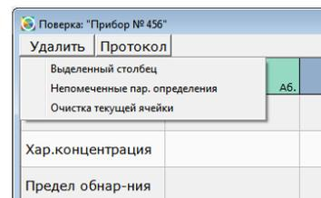
Для **удаления** из таблицы **параллельных определений** выбрать курсором ячейку с результатом для редактирования, в таблице параллельных определений снять курсором галочки с подлежащих удалению результатов, нажать кнопку **«Удалить»** > **«Непомеченные пар. определения»**.
