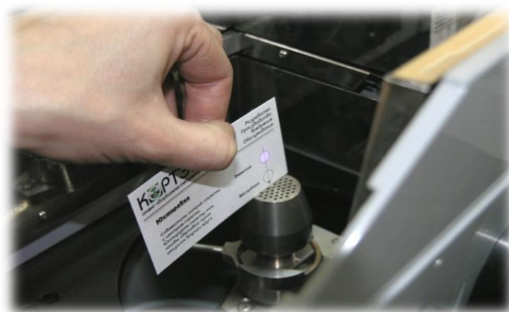
Рис. 61. Проверка положения эмиссионной горелки по юстировочной карточке
