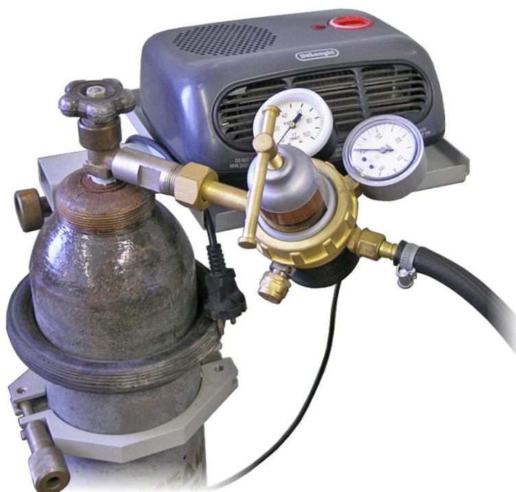
Рис.37. Подогрев редуктора при работе с закисью азота
