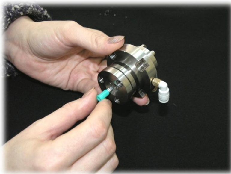
Рис. 74. Прочистка иглы распылителя с помощью приспособления
