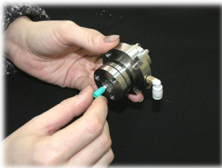
Рис. 74. Прочистка иглы распылителя с помощью приспособления
