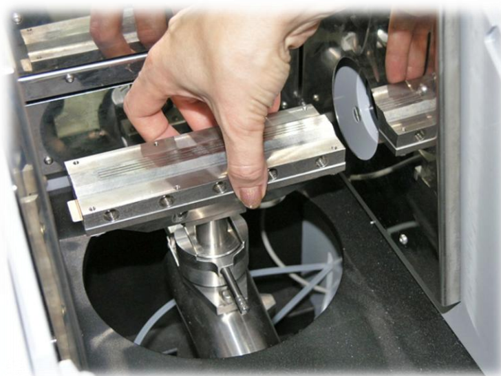
Рис. 40. Опустить горелку в зажим механизма
