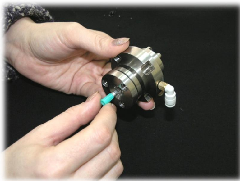
Рис. 74. Прочистка иглы распылителя с помощью приспособления
