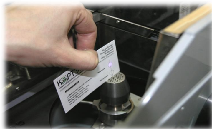
Рис. 61. Проверка положения эмиссионной горелки по юстировочной карточке
