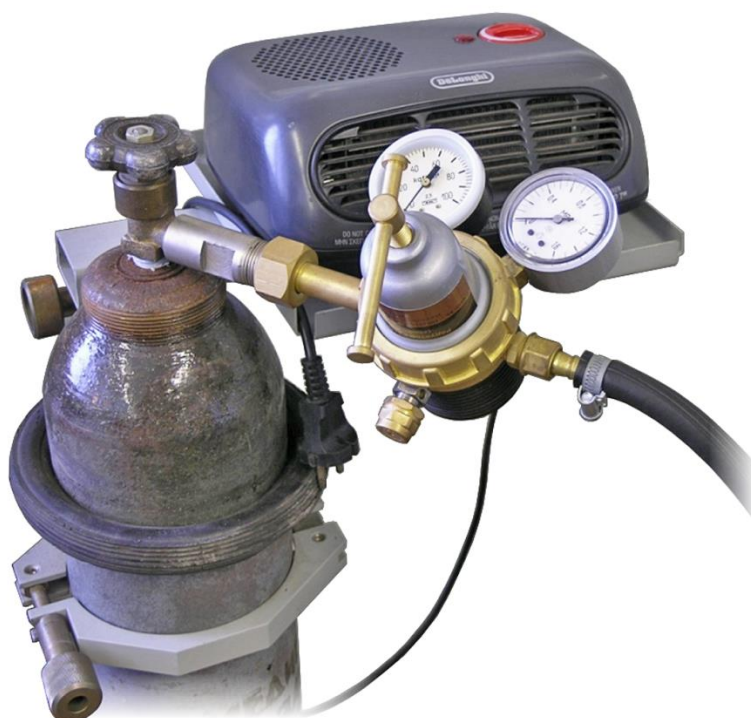
Рис.37. Подогрев редуктора при работе с закисью азота
