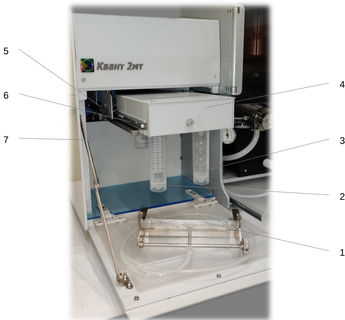
Рис. 24. Общий вид блока ГРГ
