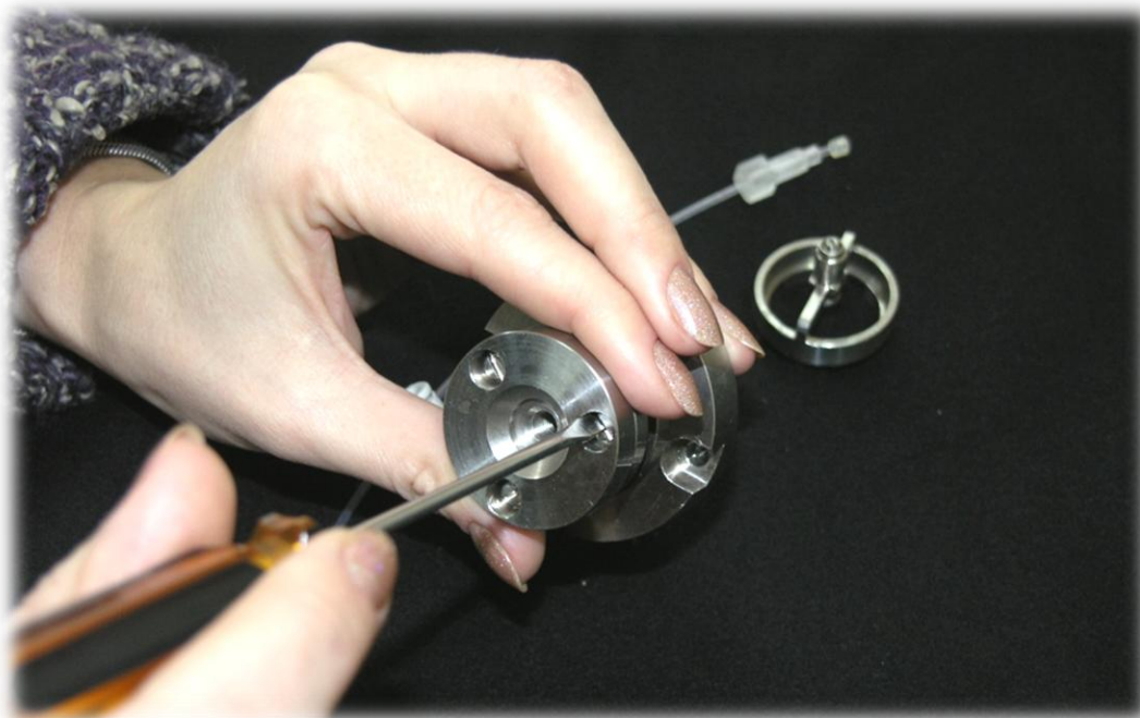
Рис.77. Снятие шайбы крепления иглы
