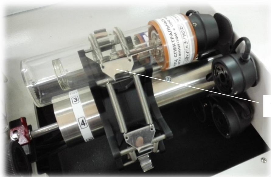
Рис. 42. Совместить ключ 1 спектральной лампы и выемку 2 ламповой панели. Вставить лампу в панель
