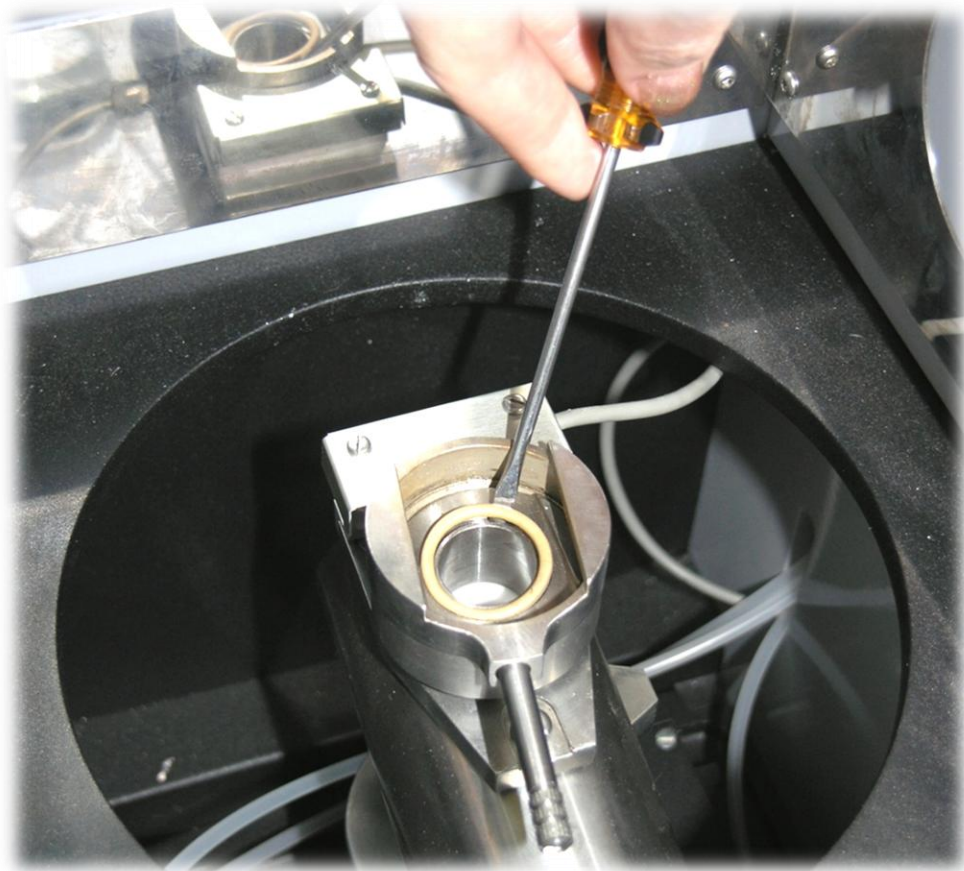
Рис. 72. Замена уплотнительного кольца камеры смешения
