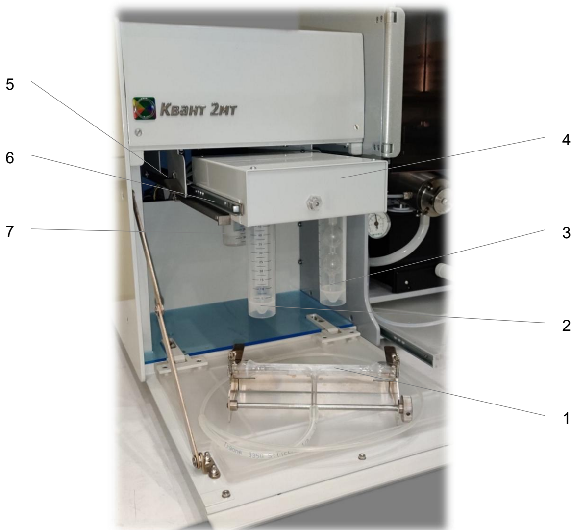
Рис. 24. Общий вид блока ГРГ
