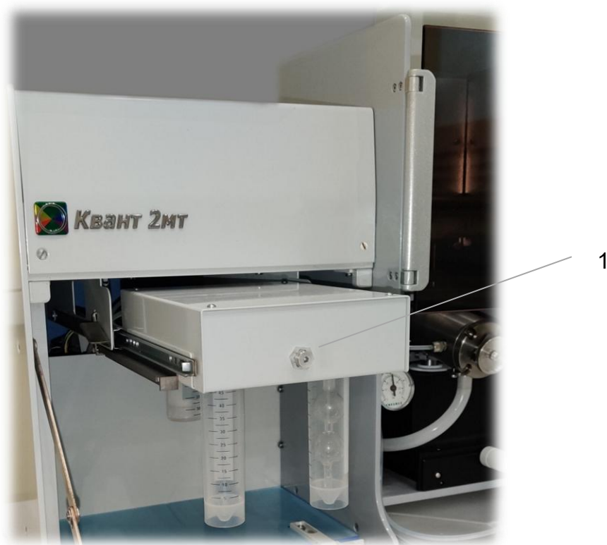
Рис. 66. Подключение трубки от кварцевой кюветы к приставке ГРГ, 1 - штуцер для подключения трубки от кюветы
