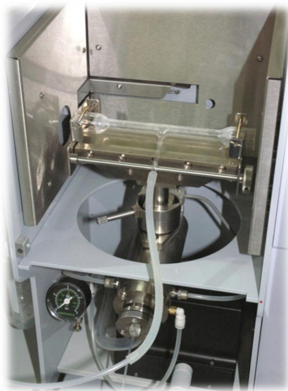
Рис.67. Установка кюветы с держателем на горелку.
