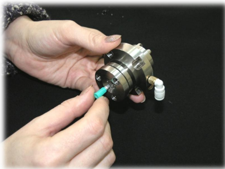
Рис. 74. Прочистка иглы распылителя с помощью приспособления
