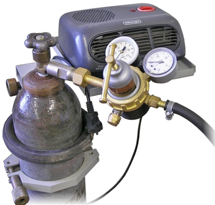
Рис.37. Подогрев редуктора при работе с закисью азота
