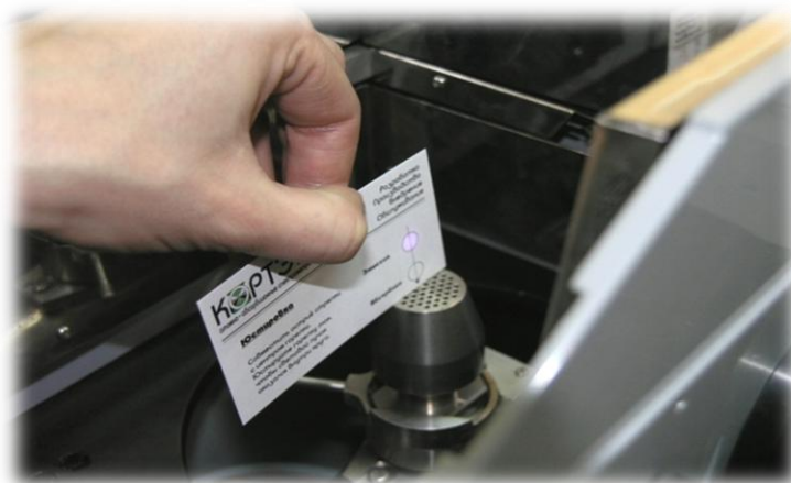
Рис. 61. Проверка положения эмиссионной горелки по юстировочной карточке
