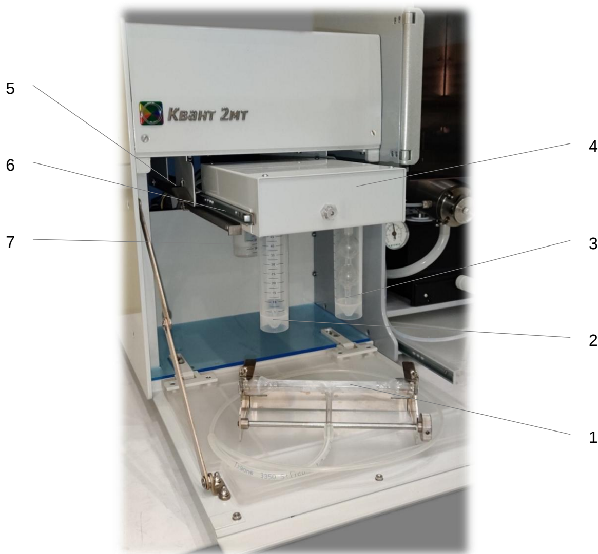
Рис. 24. Общий вид блока ГРГ
