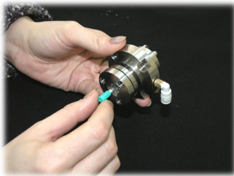
Рис. 74. Прочистка иглы распылителя с помощью приспособления
