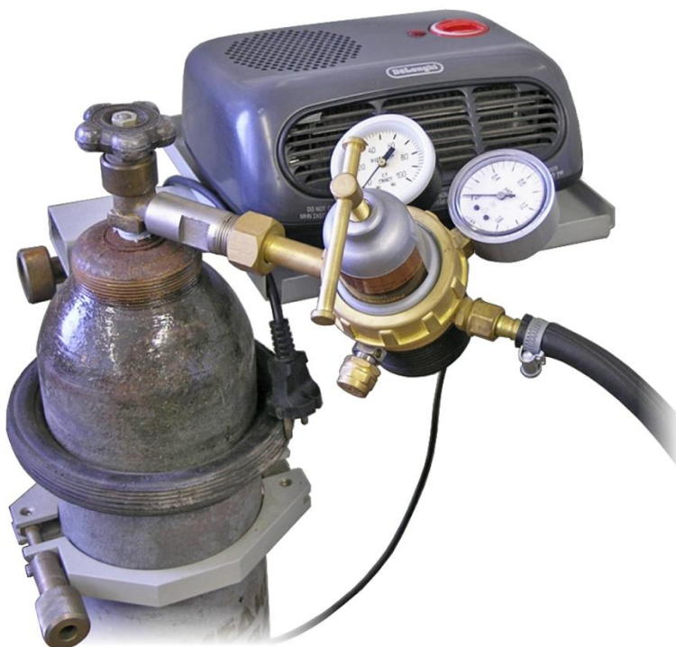
Рис.37. Подогрев редуктора при работе с закистью азота
