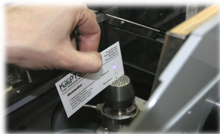
Рис. 61. Проверка положения эмиссионной горелки по юстировочной карточке
