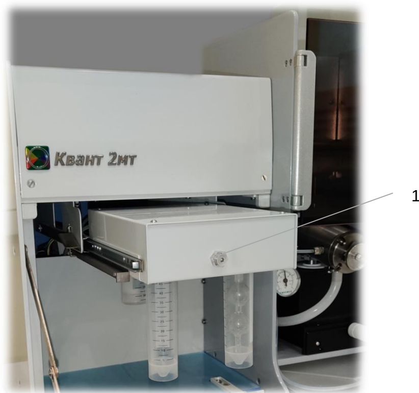
Рис. 66. Подключение трубки от кварцевой кюветы к приставке ГРГ, 1 - штуцер для подключения трубки от кюветы
