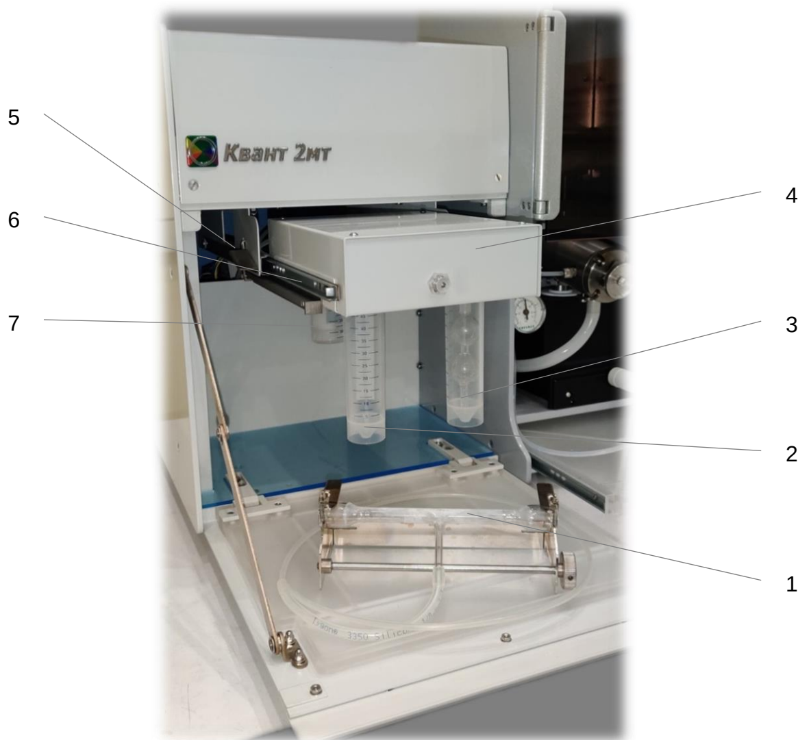
Рис. 24. Общий вид блока ГРГ
