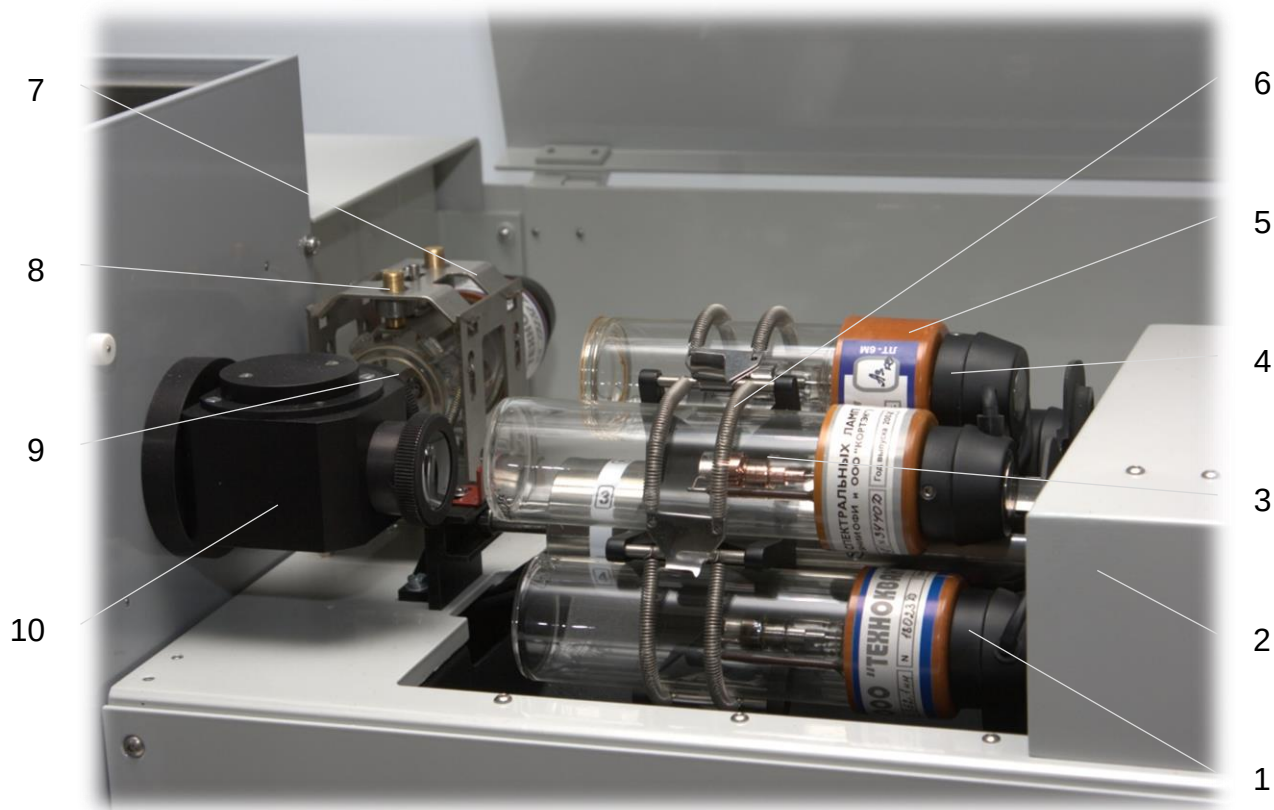
Рис. 7. Общий вид лампового отсека
