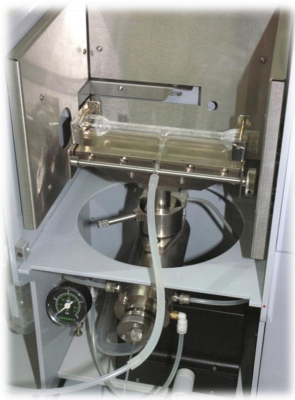
Рис.67. Установка кюветы с держателем на горелку.
