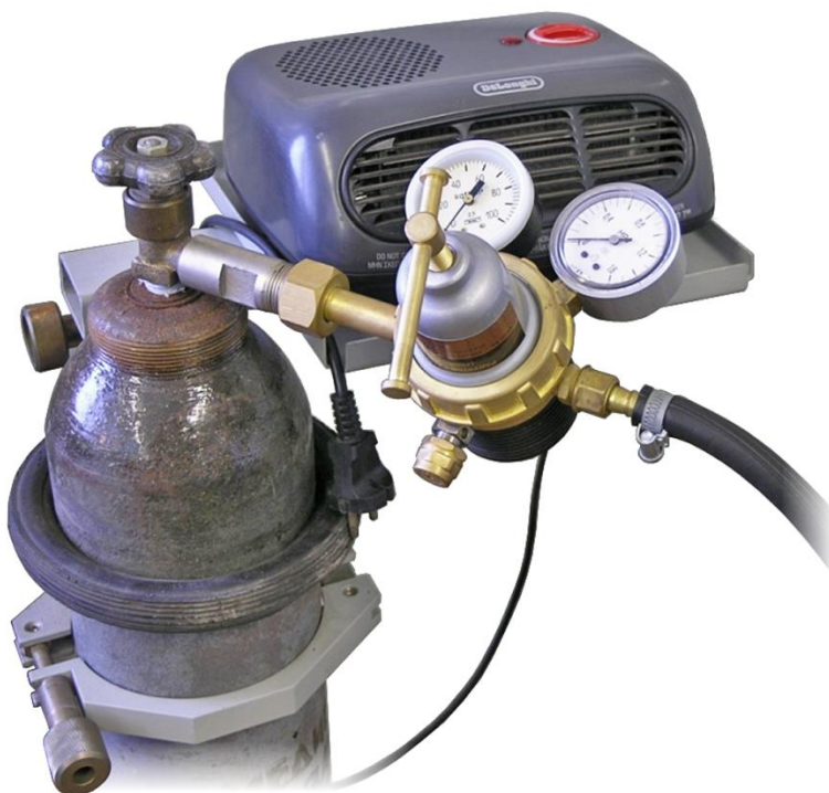
Рис.37. Подогрев редуктора при работе с закистью азота
