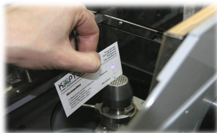
Рис. 61. Проверка положения эмиссионной горелки по юстировочной карточке
