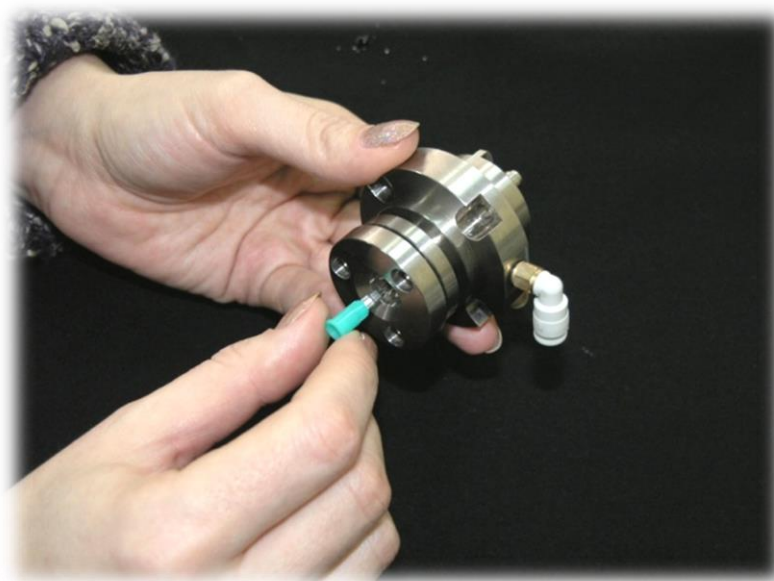
Рис. 74. Прочистка иглы распылителя с помощью приспособления
