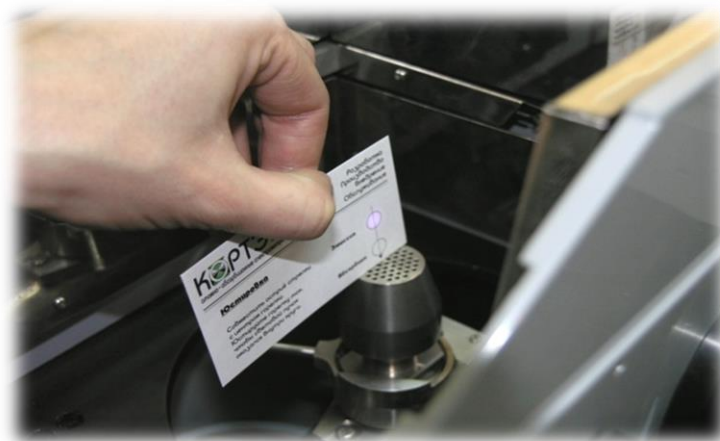
Рис. 61. Проверка положения эмиссионной горелки по юстировочной карточке
