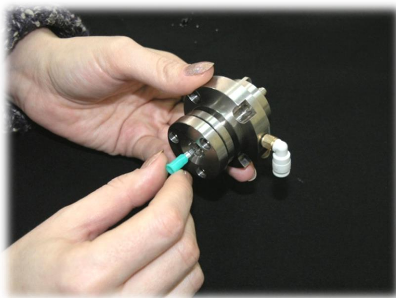
Рис. 74. Прочистка иглы распылителя с помощью приспособления
