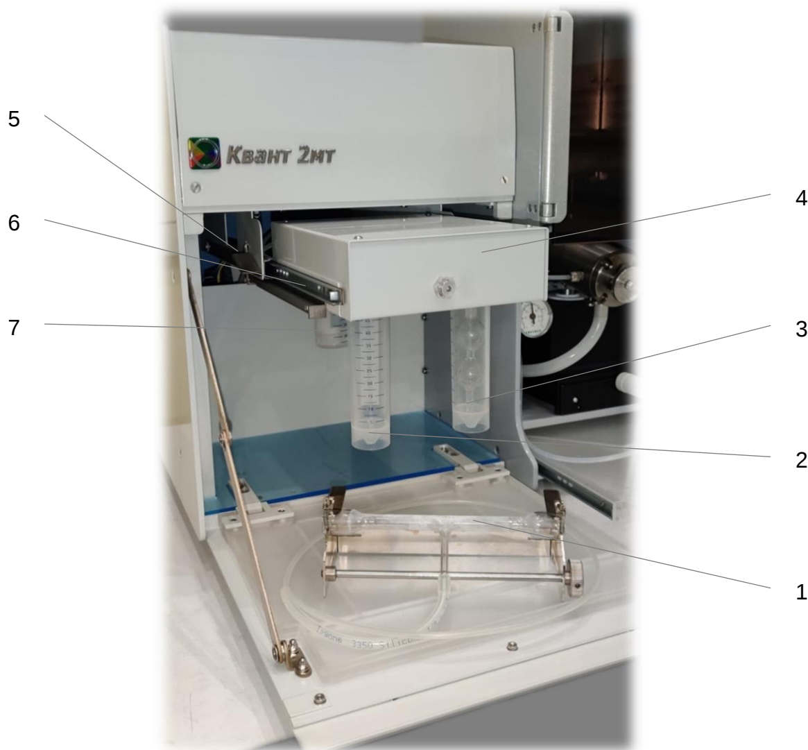
Рис. 24. Общий вид блока ГРГ
