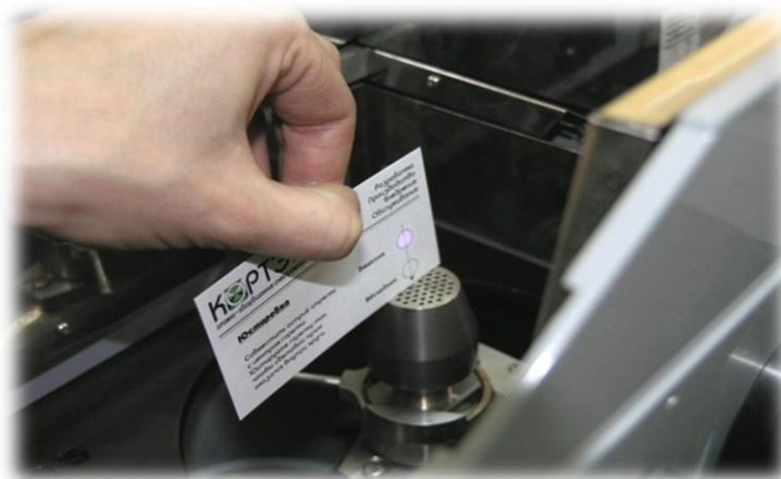
Рис. 61. Проверка положения эмиссионной горелки по юстировочной карточке
