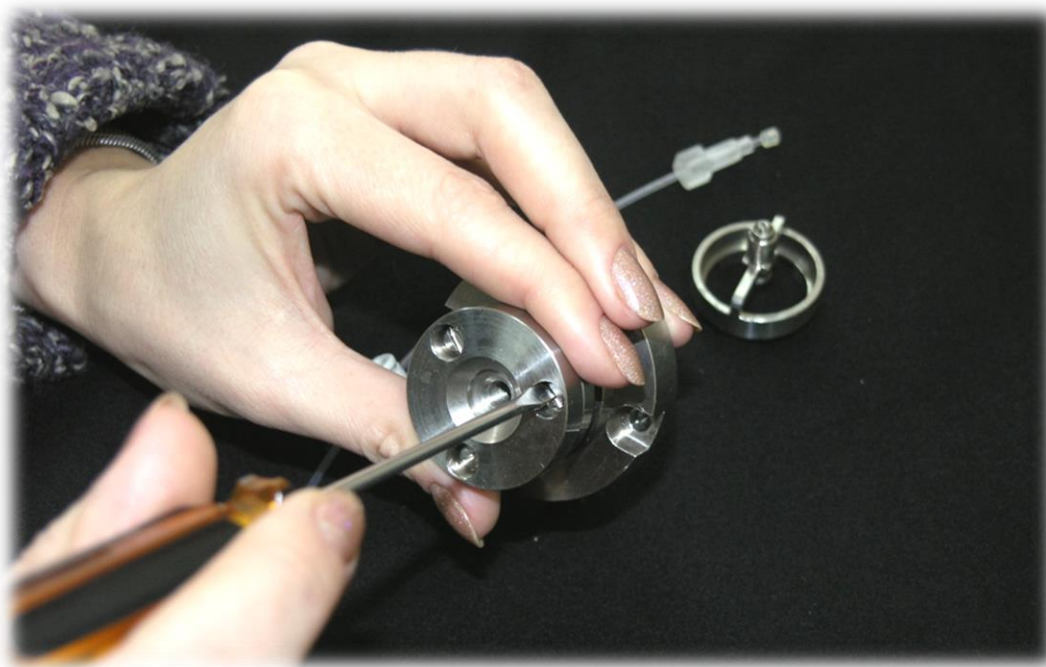
Рис.77. Снятие шайбы крепления иглы
