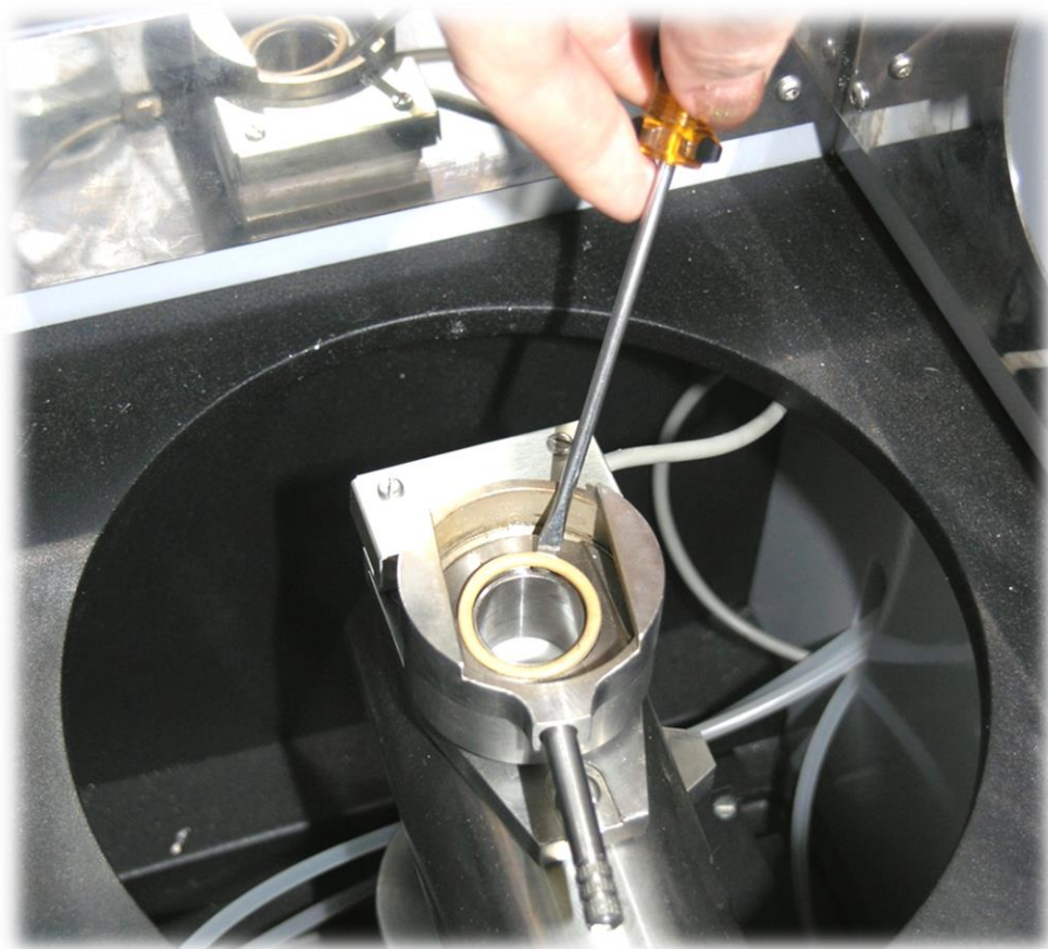
Рис. 72. Замена уплотнительного кольца камеры смешения
