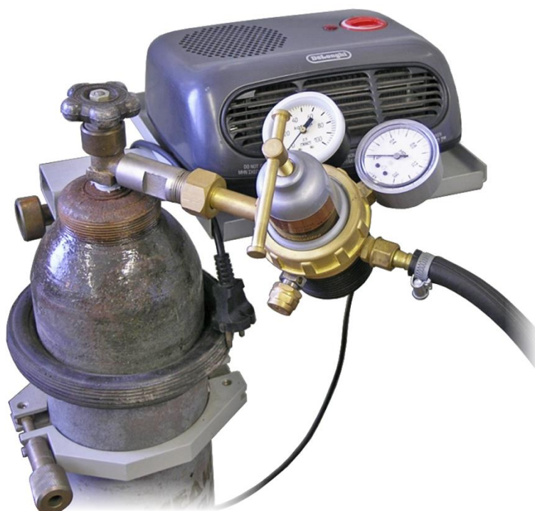
Рис.37. Подогрев редуктора при работе с закистью азота
