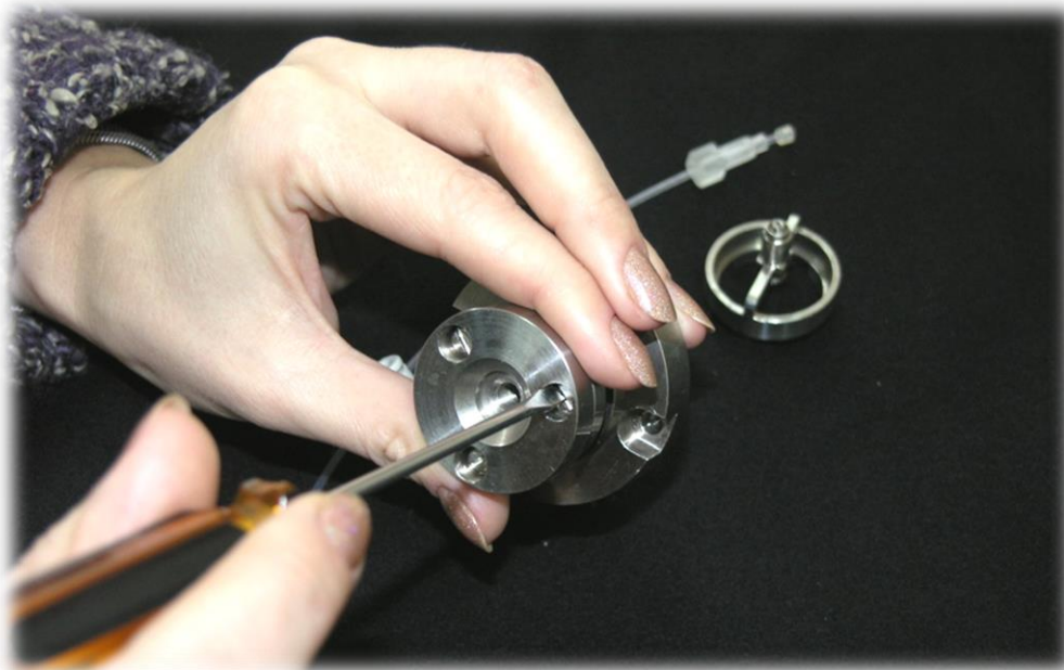
Рис. 79. Настройка расхода воздуха
