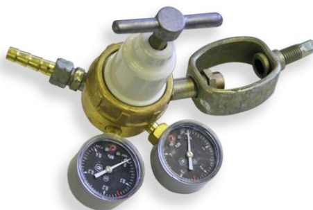
Рис. 28. Редуктор «БАО 5-4» – для ацетиленового баллона
