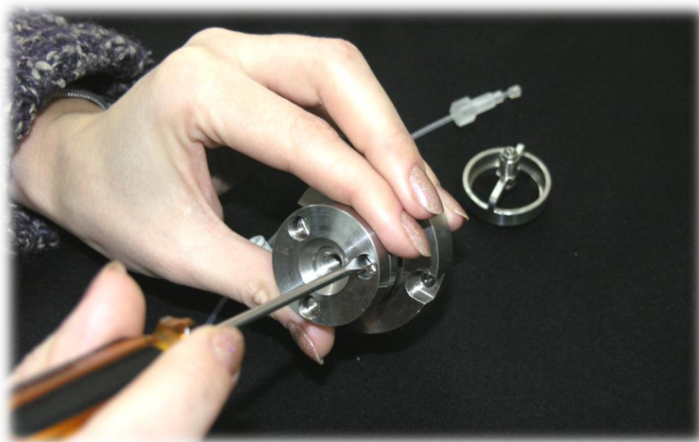
Рис. 71. Настройка расхода воздуха
