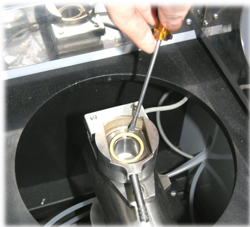
Рис. 64. Замена уплотнительного кольца камеры смешения
