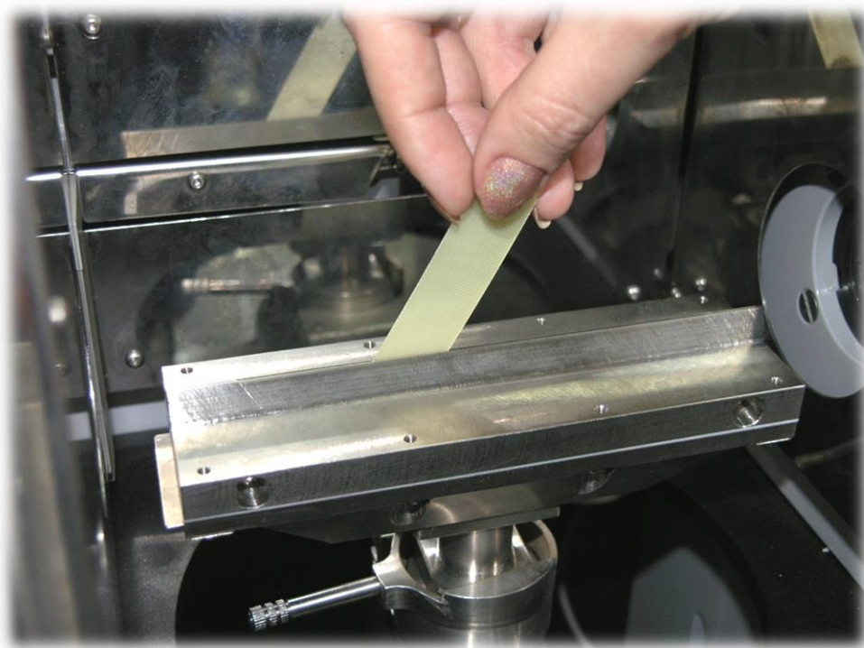
Рис. 63. Механическая очистка горелки
