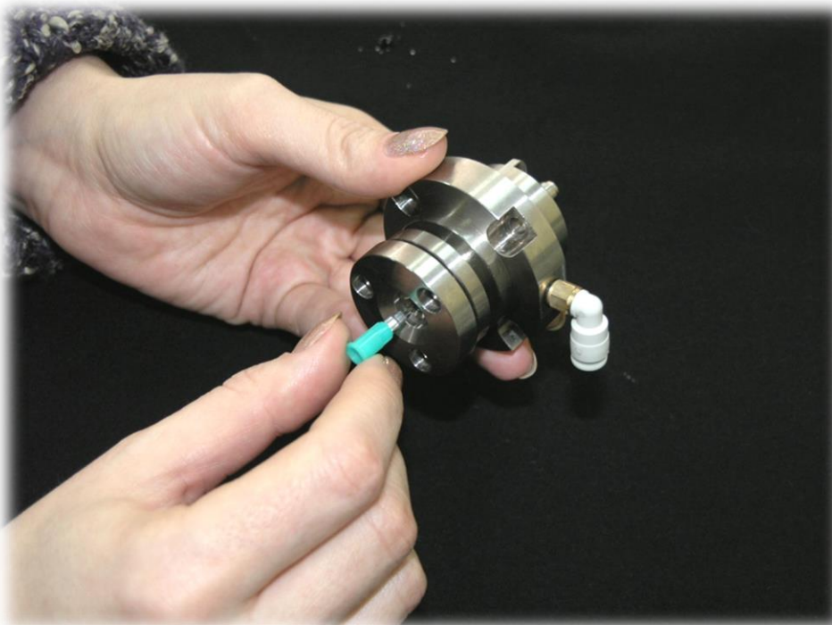
Рис. 66. Прочистка иглы распылителя с помощью приспособления
