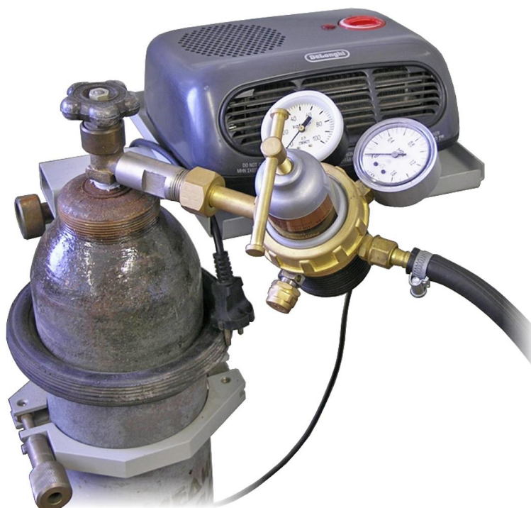
Рис.35. Подогрев редуктора при работе с закисью азота
