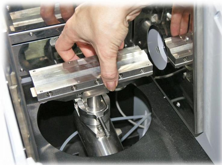
**Рис. 38.** Опустить горелку в зажим механизма
