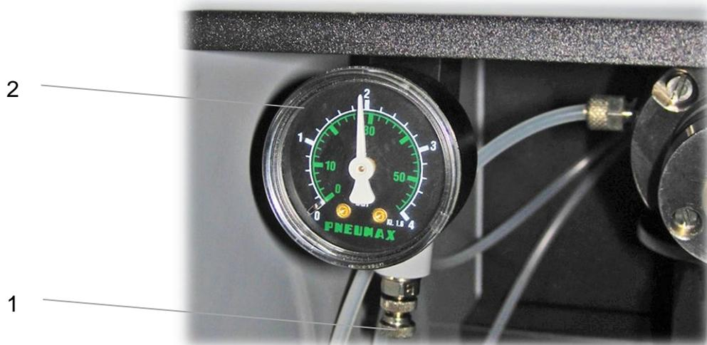
**Рис. 18** Блок регулировки давления распылителя
