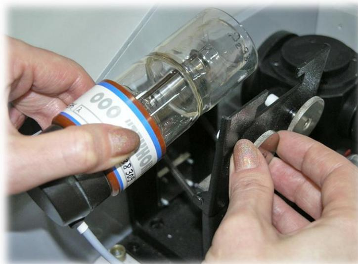
**Рис. 43.** Вставить дейтериевую лампу в панель.
