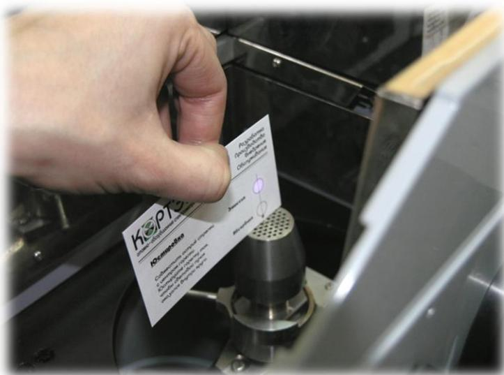
Рис. 60. Проверка положения эмиссионной горелки по юстировочной карточке
