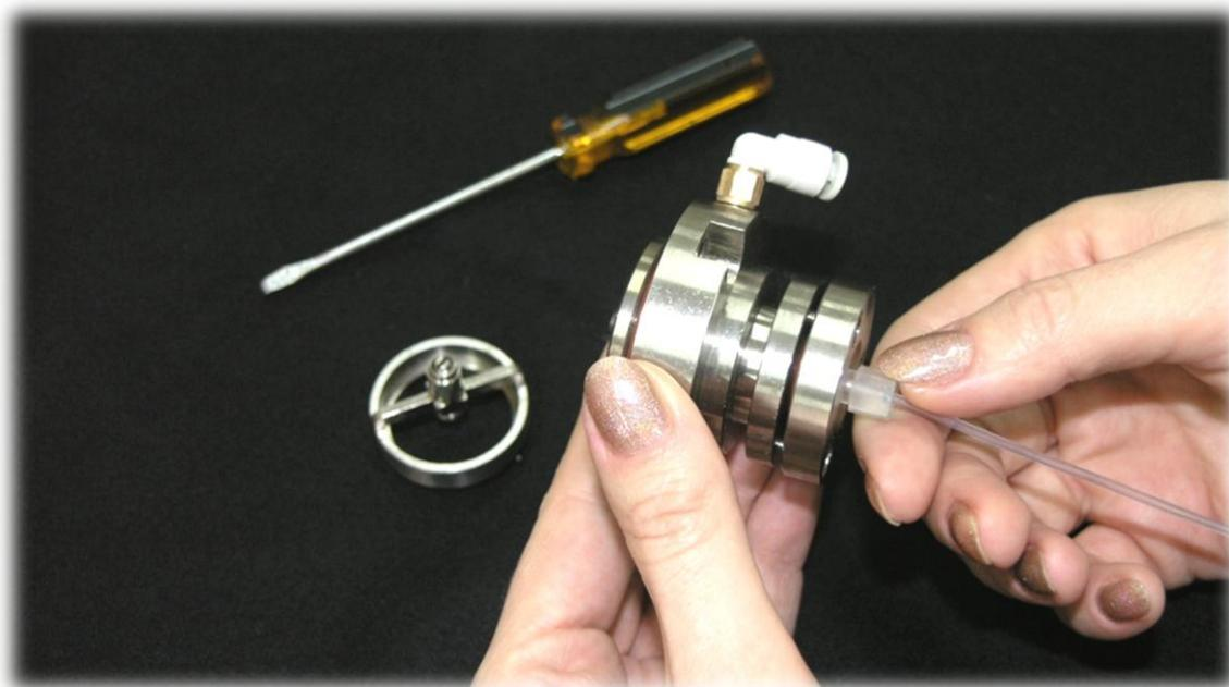
**Рис. 68. Снятие капилляра**
