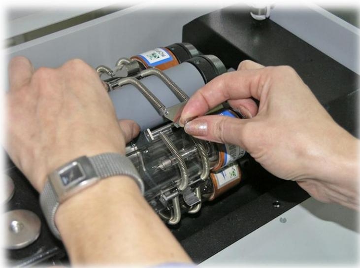
**Рис. 40.** Снять фиксирующие пружины и удалить имитатор лампы, вынув его из ламповой панели
