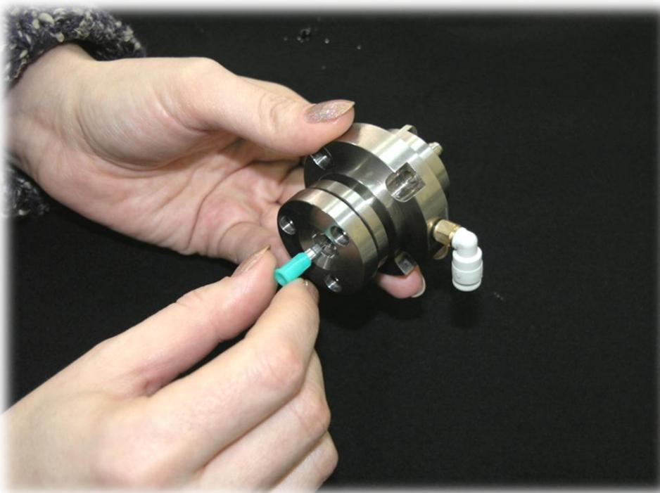
**Рис. 66.** Прочистка иглы распылителя с помощью приспособления
