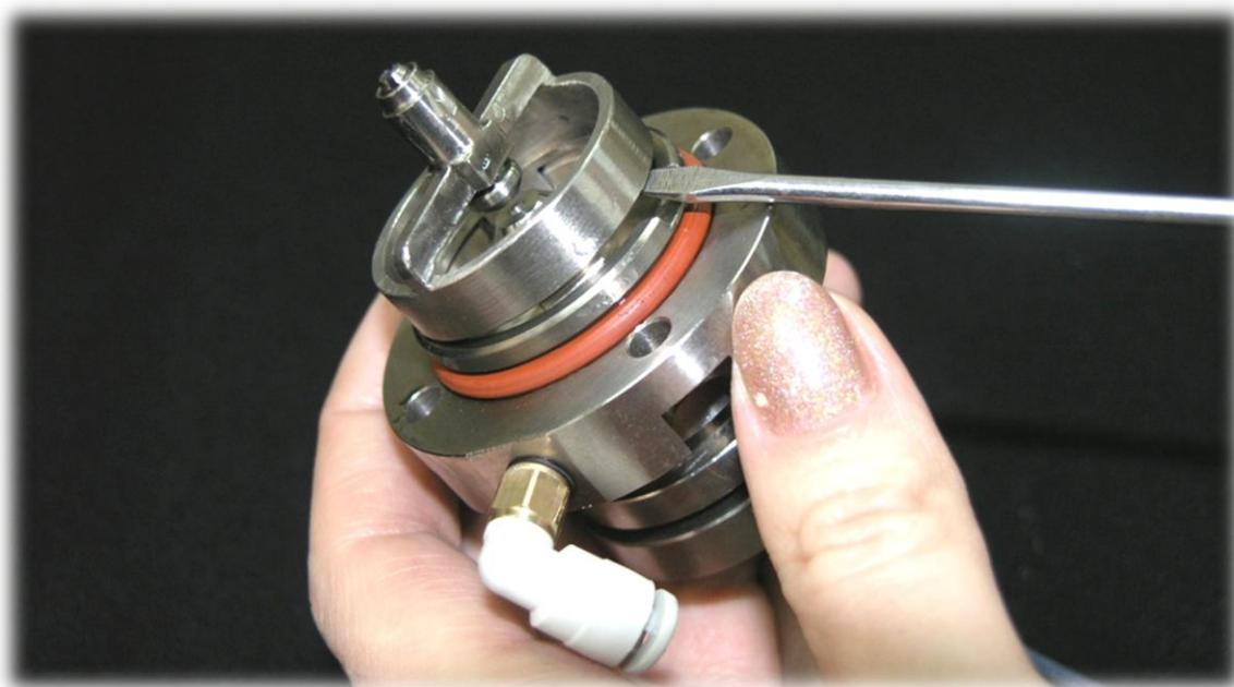
*Рис. 67.* Снятие импактора
