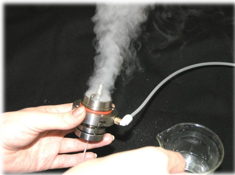
**Рис.72.** Проверка качества пыления
