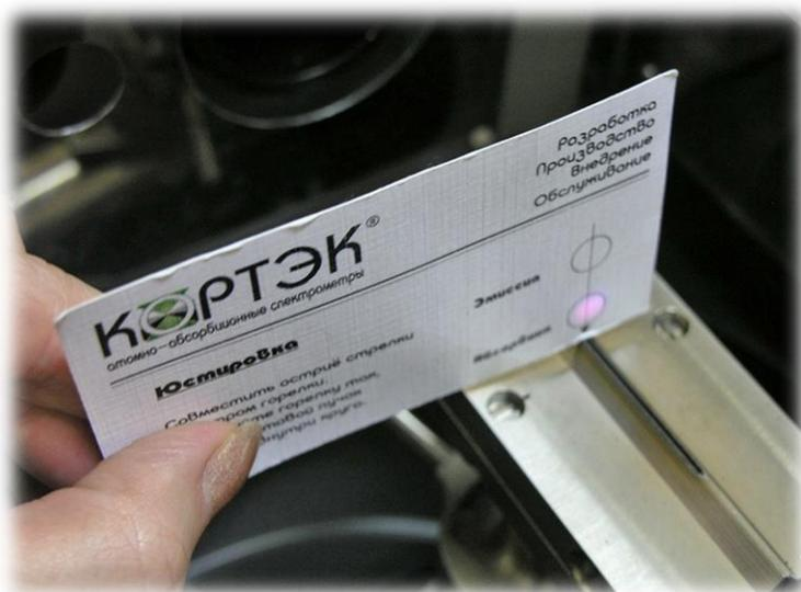
**Рис. 50.** Проверка положения горелки по юстировочной карточке
