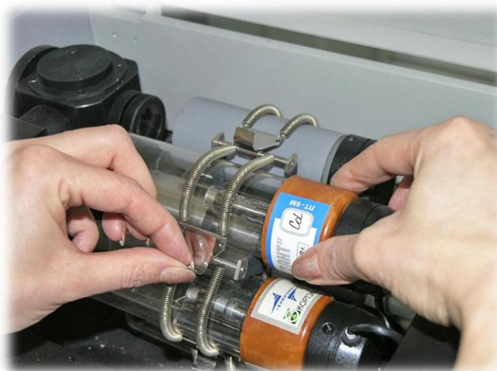
**Рис. 42.** Установить лампу в держатель и зафиксировать пружиной
