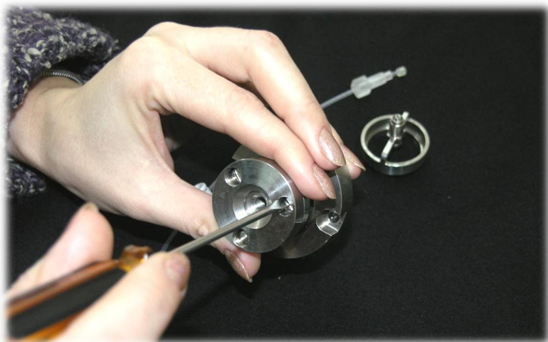
**Рис.69. Снятие шайбы крепления иглы**
