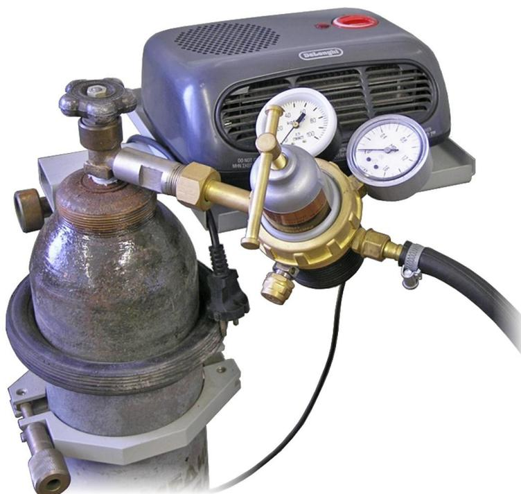
**Рис.35.** Подогрев редуктора при работе с закисью азота
