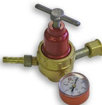
**Рис. 29.** Редуктор «БПО 5-4» – для пропанового баллона с вентильным запорным устройством (может использоваться только с блоком подготовки газов)
