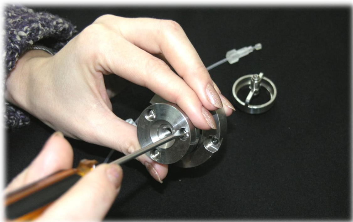
Рис.69. Снятие шайбы крепления иглы
