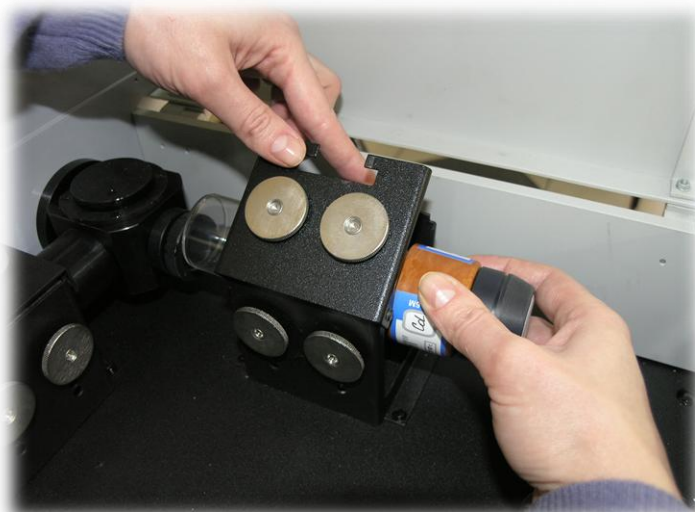
Рис. 42. Установить лампу в держатель и зафиксировать пружиной
