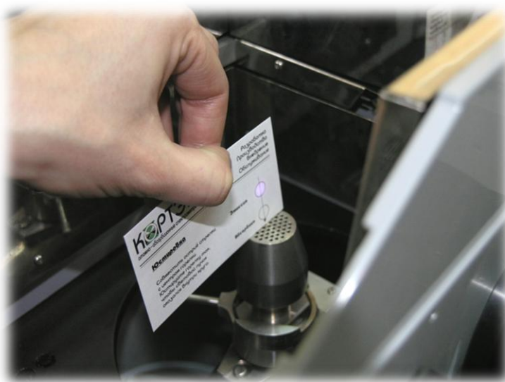
Рис. 60. Проверка положения эмиссионной горелки по юстировочной карточке
