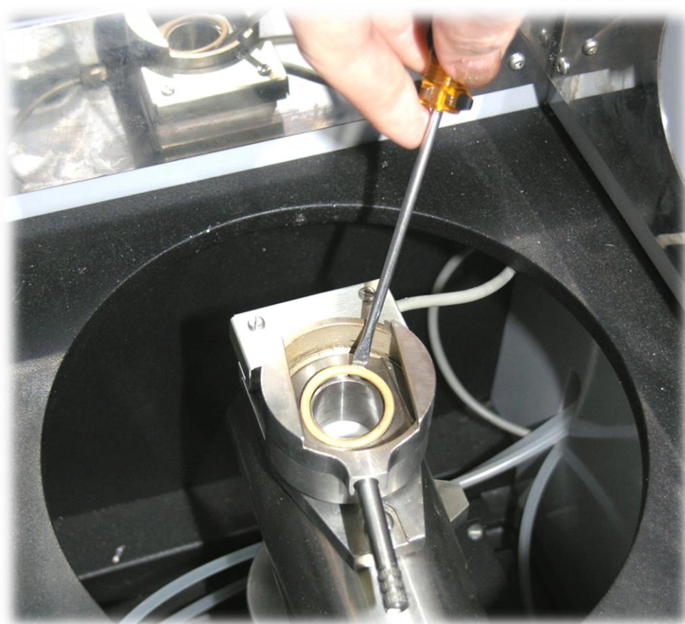
Рис. 64. Замена уплотнительного кольца камеры смешения
