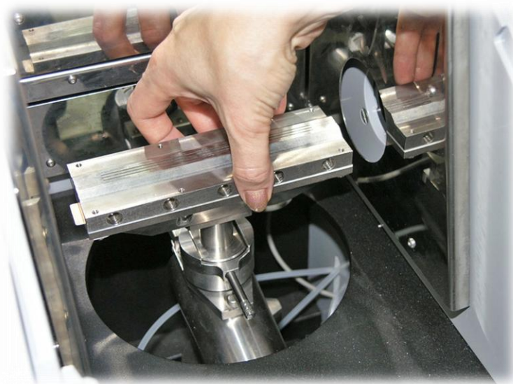
Рис. 38. Опустить горелку в зажим механизма
