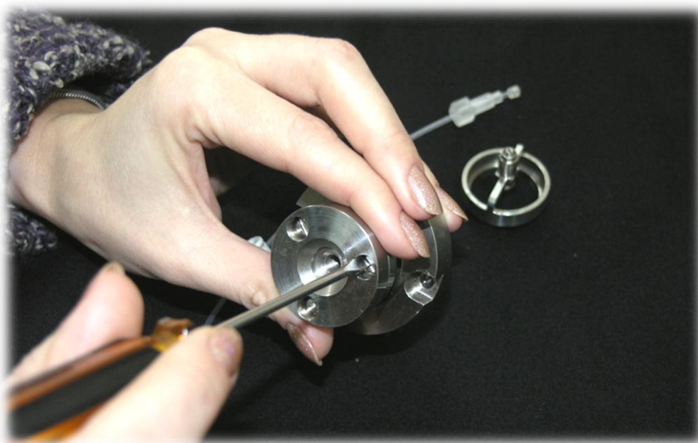
Рис. 71. Настройка расхода воздуха
