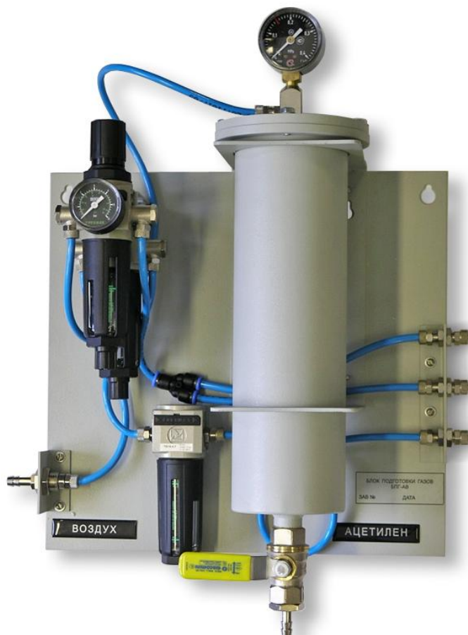
Рис. 27. Блок подготовки газов ацетилен - воздух
