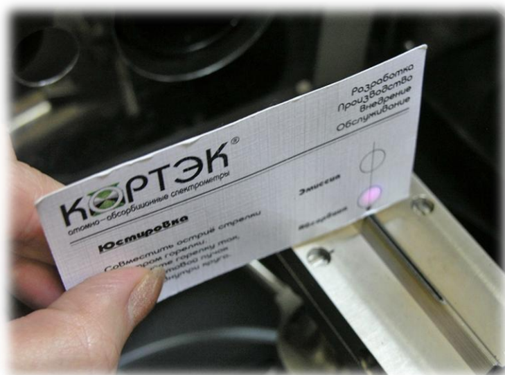
Рис. 50. Проверка положения горелки по юстировочной карточке
