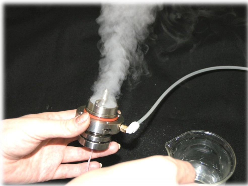
Рис.72. Проверка качества пыления
