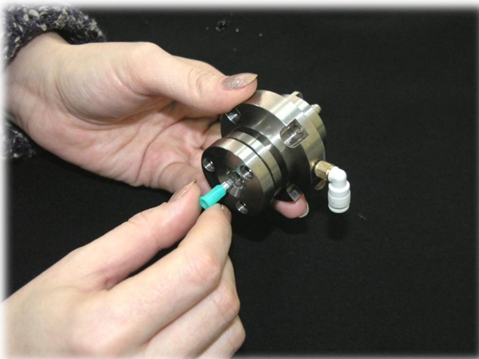
Рис. 66. Прочистка иглы распылителя с помощью приспособления
