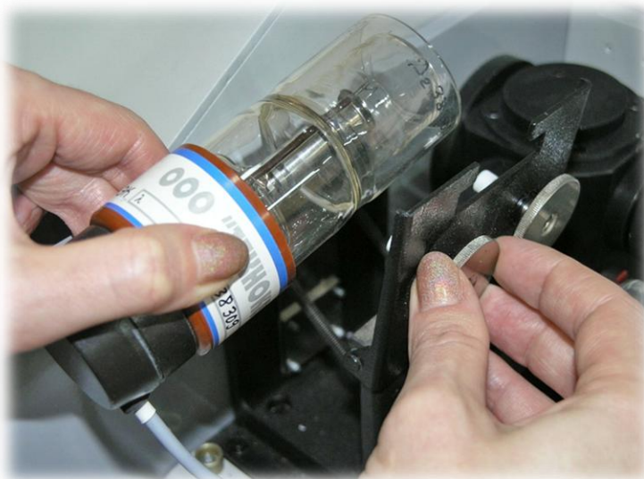
Рис. 43. Вставить дейтериевую лампу в панель. Установить в ламподержатель.
