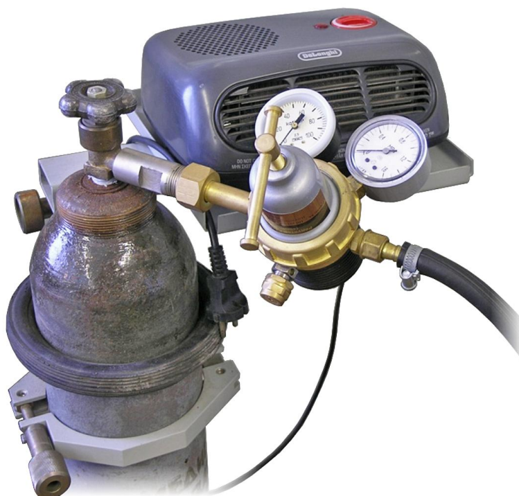
Рис.35. Подогрев редуктора при работе с закисью азота
